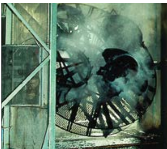
ROMOLD produkcja - formowanie rotacyjne (chłodzenie wodą)
