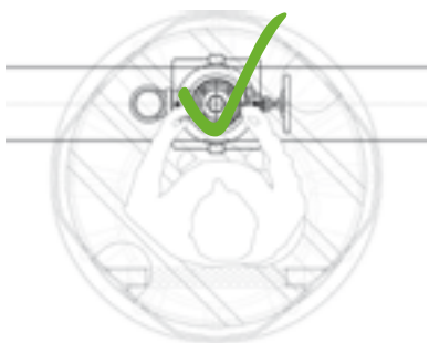
rurociąg wprowadzony mimośrodowo
