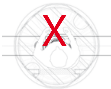
rurociąg wprowadzony centrycznie
