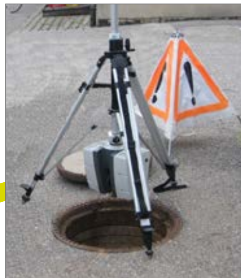
Szczegółowy pomiar istniejącej studni
