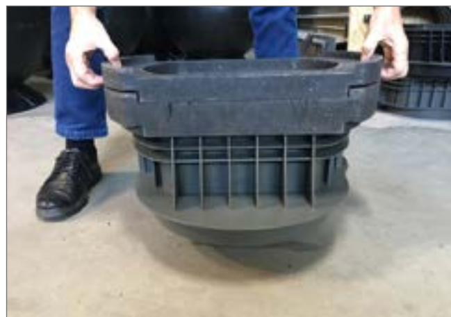
niewielka wytrzymałość na rozciąganie między elementami
