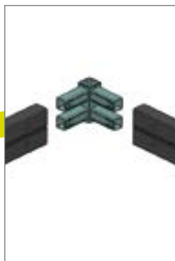
Podzielna w pionie, profil z narożnym łącznikiem, otwór drenażowy w płycie dolnej
