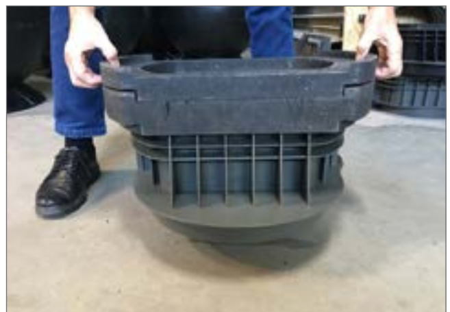
niewielka wytrzymałość na rozciąganie między elementami
