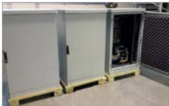
Obudowa stacji sprężonego powietrza-440
