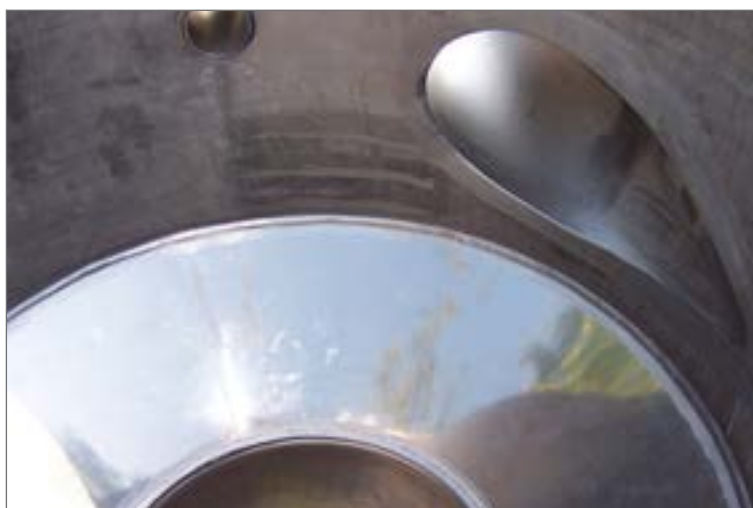
Widok wnętrza z króćcem dopływu oraz kulistym dnem
